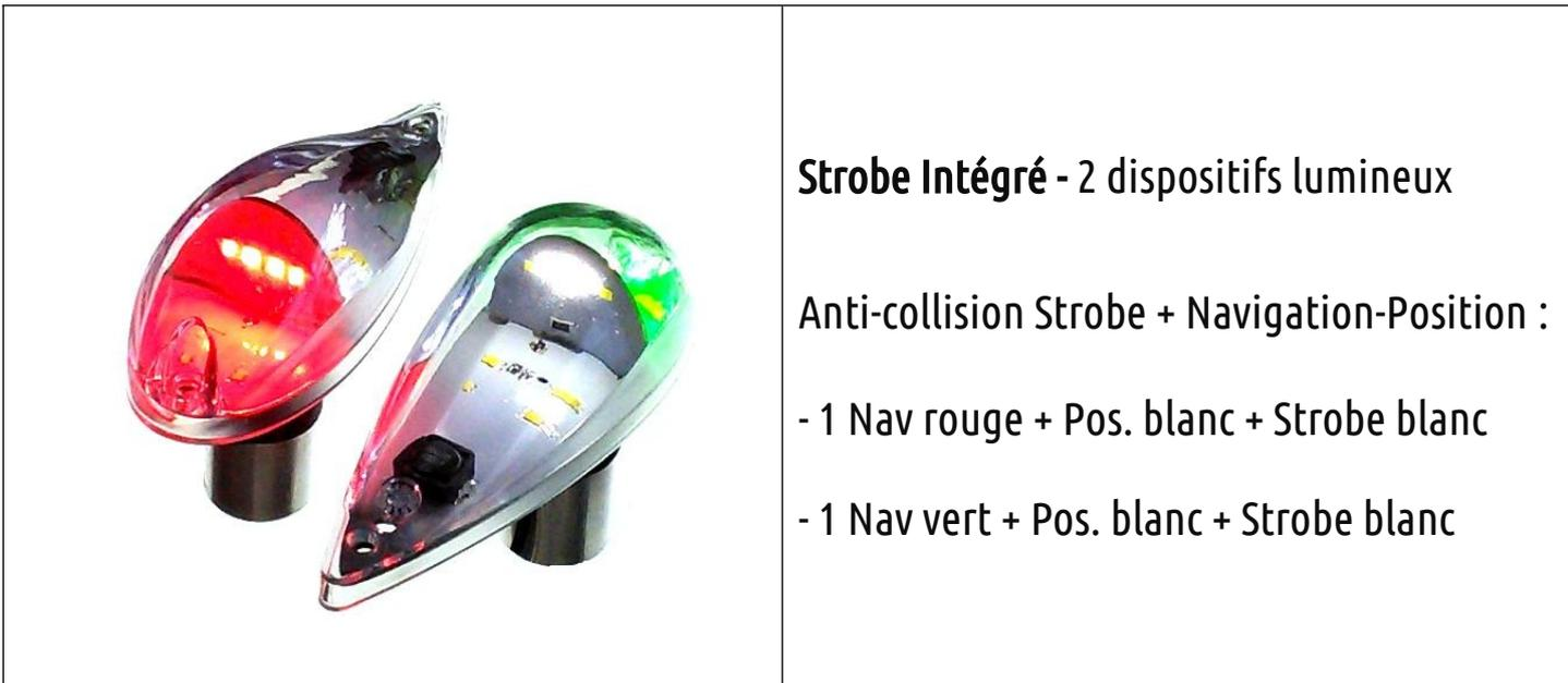
Le kit Strobe Double Intégré comprend 2 dispositifs lumineux. Chacun produit un flash à 180° + une lumière blanche à l'arrière et une lumière rouge ou verte à l'avant. La position idéale est en bout d'ailes. Il est possible d'actionner les flashes seuls, les feux de Nav-Positions seuls, ou les deux.
